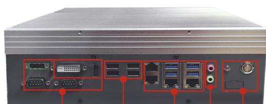
1*DC IN 1*DVI 1*HDMI 2*COM 4*USB2.0 4*RJ45 4*USB3.0 2*音频接口 1*硬盘指示灯 1*电源开关 1*远程开关接线半破口
